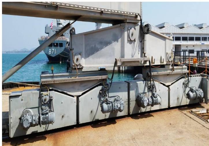
รูปที่ ๑๐ Gear Motor ขับเคลื่อนเครน
