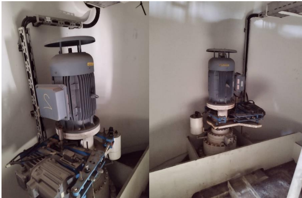
รูปที่ ๑๑ Gear Motor ขับหมุนรอบตัวเครน
